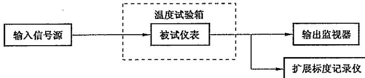
图 6 环境温度影响试验配置示意图
