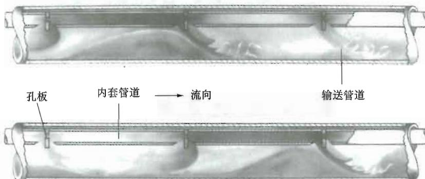
图 10-1 双套管输送原理图
