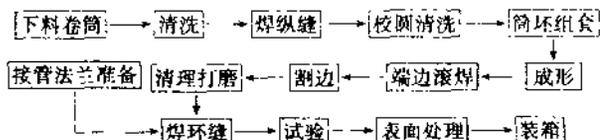
图 8-1 波纹膨胀节的制造工艺
